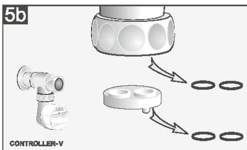
Austauschzähler Allmess Controller-V
