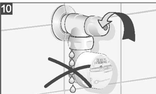
Ventil öffnen, Dichtigkeit prüfen
