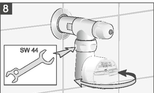
Zähler ausrichten und festziehen, Kontrolle Festsitz!
